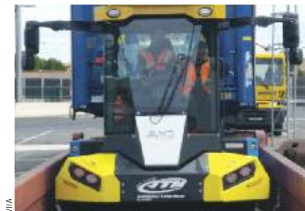
Deux vues du tracteur électrique Blyd actuellement testé par VIIA sur la plateforme de transport combiné du Boulou.
